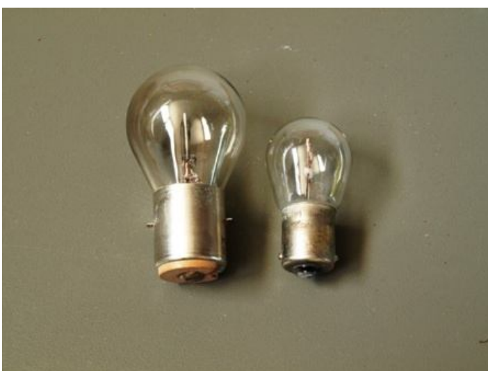
Vergleich Lampe für Nebellicht (links) und für Blinklicht (rechts)
