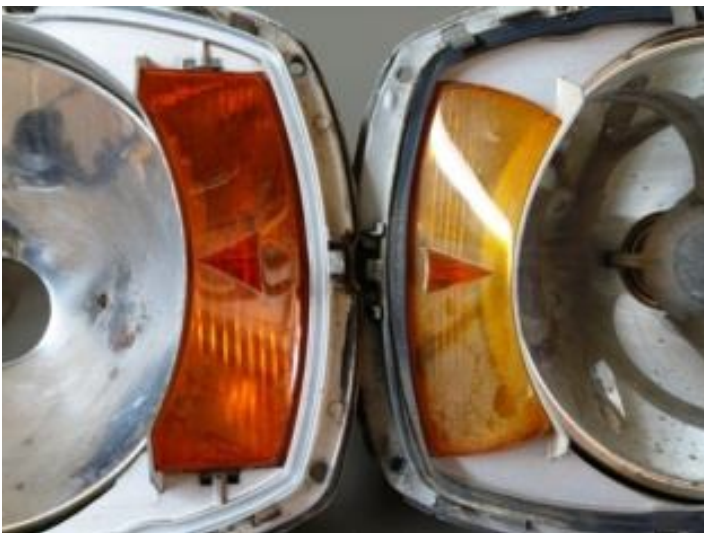
Unterschied beim Blinklicht (links BOSCH, rechts Hella)
