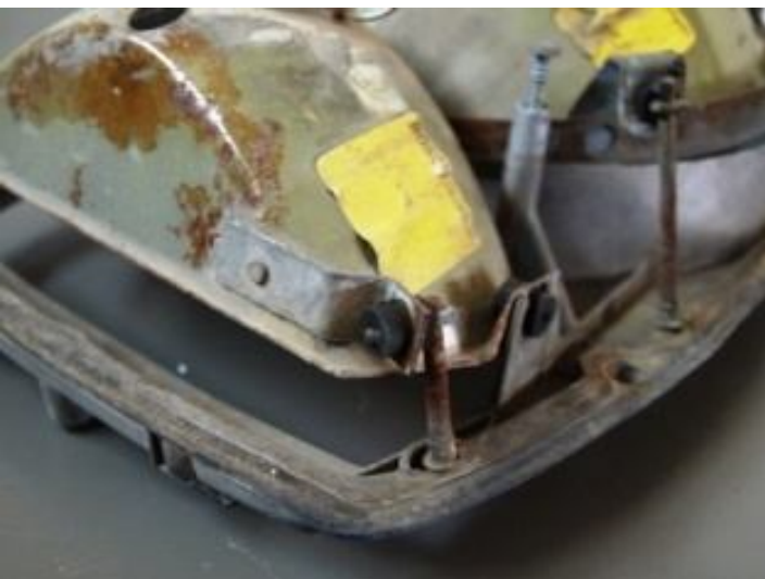
Leuchte von BOSCH mit kurzer Einstellschraube
