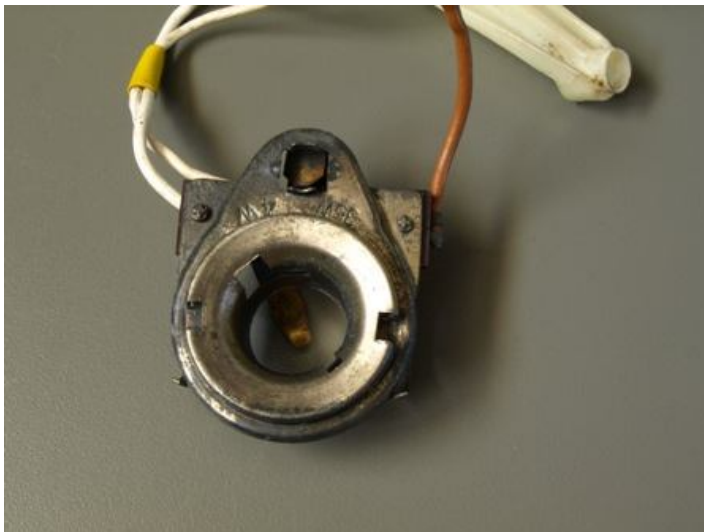
spätere Version ausgebaut von unten (hier BOSCH aus Formblech)
