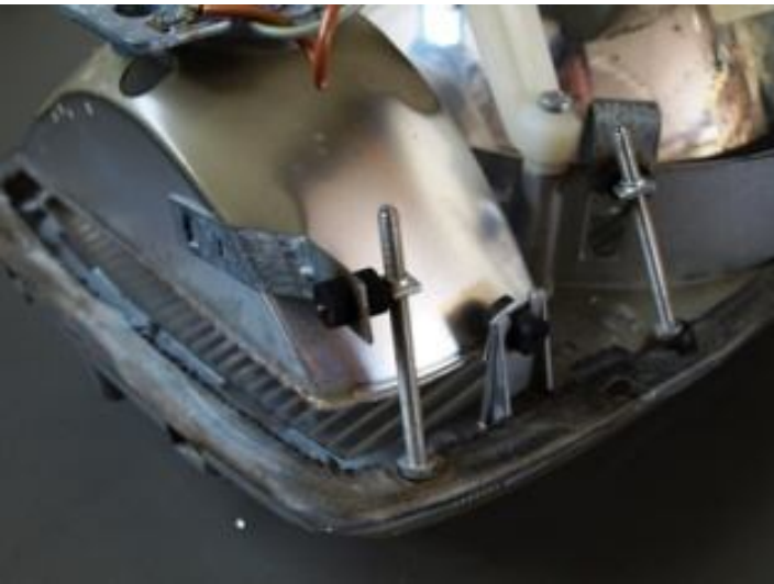
Leuchte von Hella mit langer Einstellschraube
