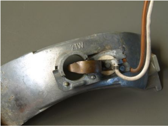
Reflektor ausgebaut ohne Lampe
