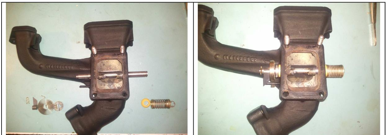
Die Klappe muss in der korrekten Position mit der Achse an 2 Punkten verschweißt werden
