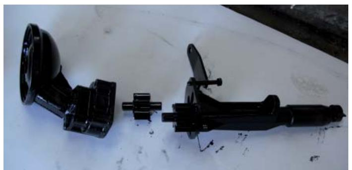
Die zerlegte Ölpumpe (vor der Reinigung)
