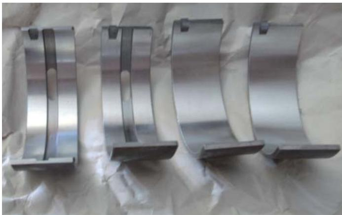
Beispiel für neue Lagerschalen. Man erkennt deutlich die Passnasen und Ölkanäle und -bohrungen.
