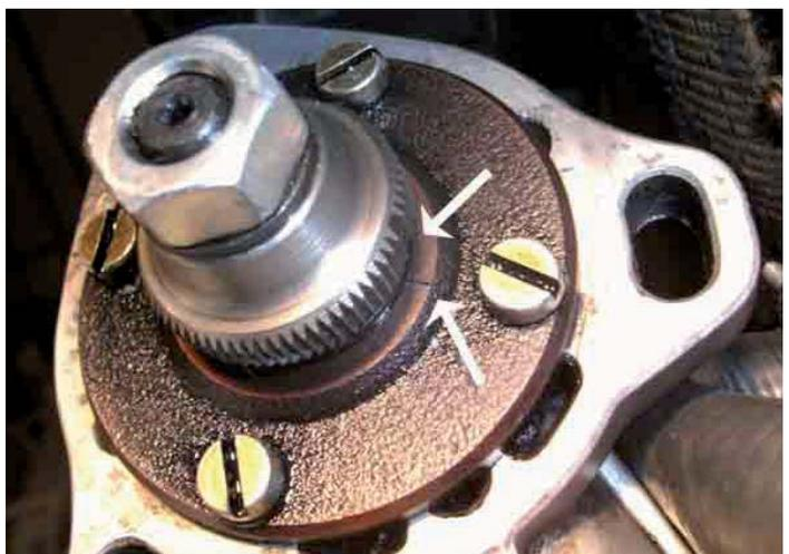
ESP Einbau: beide Markierung zur Deckung bringen
