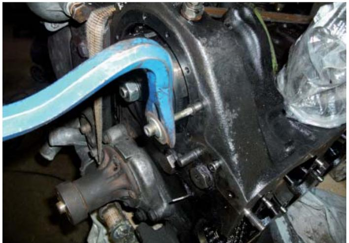
Eigentlich bei dieser Reparatur nicht notwendig, aber mit einer Schraube im Splint und einem Hebeleisen kann man die Splinte der Kettenführung ziehen oder rauskloppen.
