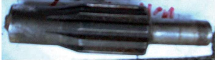
Kupplungsdorn (hergestellt aus einer abgesägten Getriebewelle)
