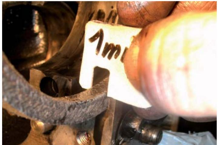
Am Ende der Dichtung setzt man die selbst angefertigte Blechsablone auf, um dann die Dichtung mit einem Messer sauber schneiden zu können.
