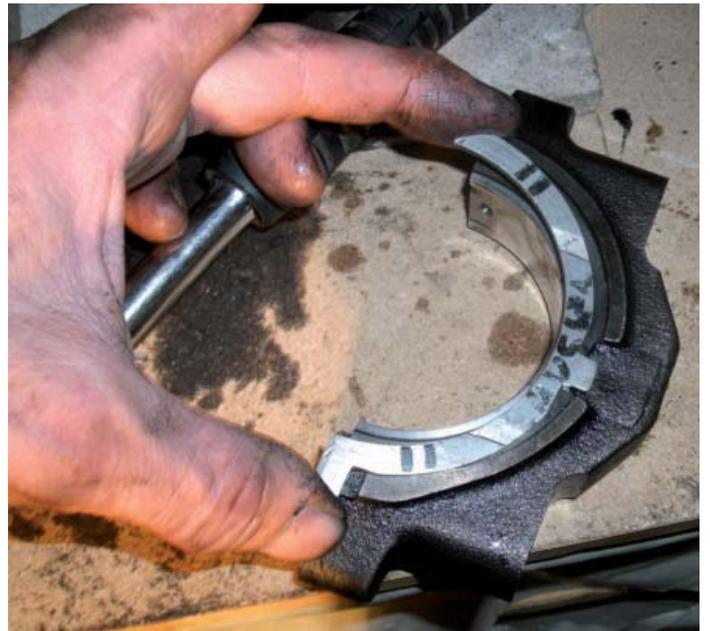
Mittleres Kurbelwellenlager mit Passscheibe
