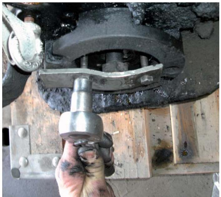
Selbst angefertigter Abzieher für die vordere Schwungscheibe
