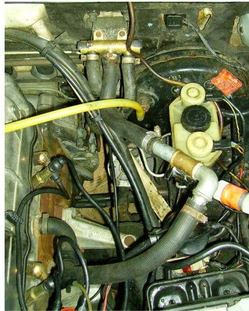
Das Schlauchstück im Motorraum verbaut: 1 Schlauch vom Motor (an der anderen Seite losgemacht), 2 Zusatzschlauch am Heizungsventil angeschlossen, 3 Zwischen den Schläuchen montierter selbstgebauter Wasserhahnanschluss (hier modernisiert mit Winkelstück), 4 Wasserhahn mit angeschlossenem Gartenschlauch.
