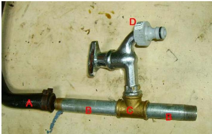
Anschlussstück aus Sanitärteilen selbst gebaut: A altes Schlauchstück, B zwei Rohrnippel  $\frac{1}{2}$  Zoll, C T-Stück  $\frac{1}{2}$  Zoll, (Später habe ich die Konstruktion leicht verändert und noch ein Winkelstück  $\frac{1}{2}$  Zoll dazwischen gesetzt), D Wasserhahn mit  $\frac{1}{2}$  Zollanschluss hinten und  $\frac{3}{4}$  Zoll Anschluss vorne mit aufgesetztem Gardena-Anschluss
