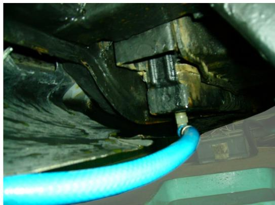
Links: Schlauchstutzen mit Gewinde 14x1,5, Rechts Schlauchstutzen unten am Kühler montiert
