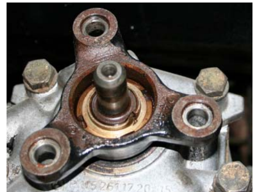
Hinter der Hardyscheibe greift eine Hülse („Zentrierbüchse“) auf diesem Zapfen (hier Getriebeseite)
