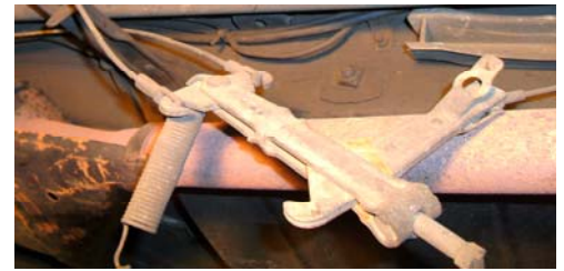
Die ausgehangene Mechanik der Handbremsumlenkung unter dem Kardantunnel
