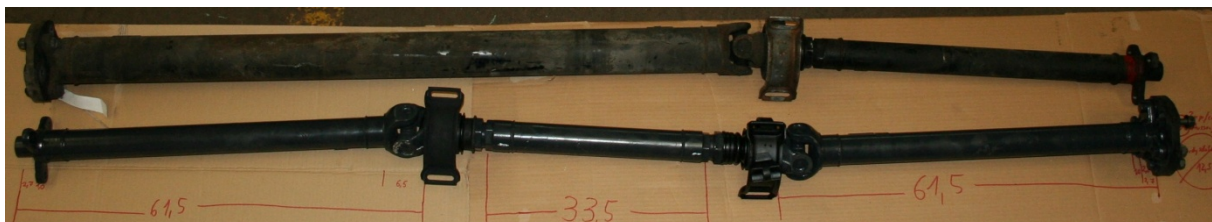
Eine zweiteilige und eine dreiteilige Kardanwelle aus dem /8
