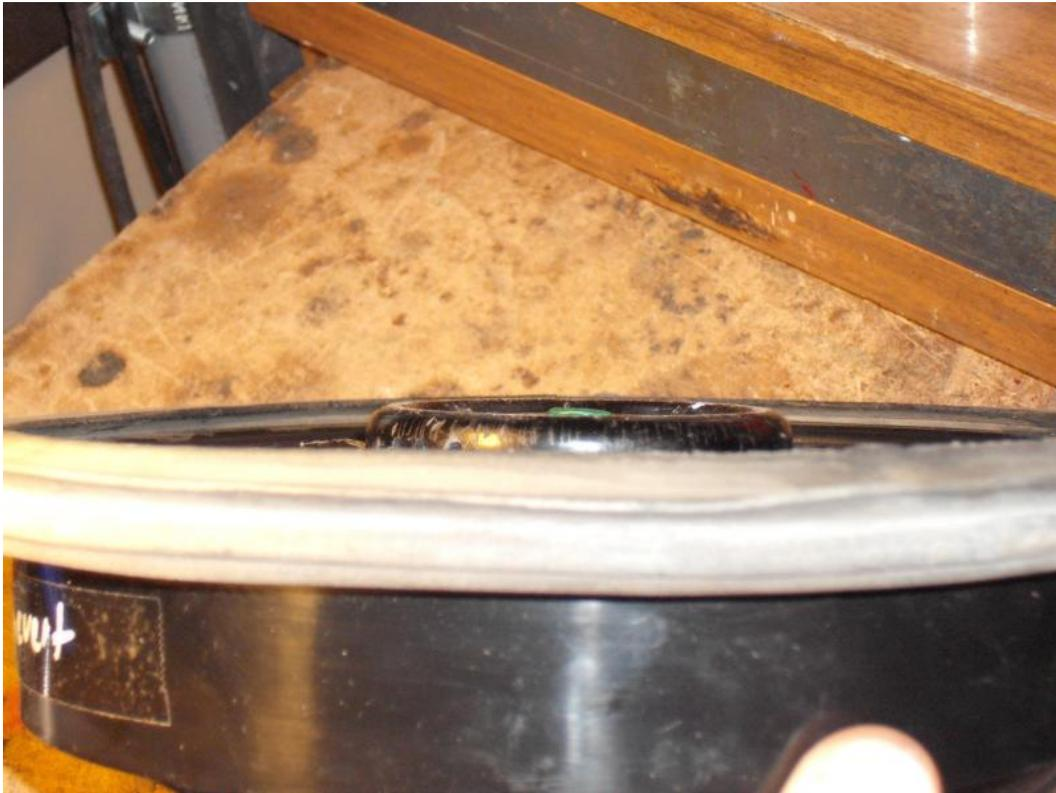
Jetzt noch den Motor mit Kondensatoren (an den Anschlüssen unter dem weißem Montagesilikon) entstören (siehe Anhang), das Kabel anlöten und eigentlich sollte der Lüfter dann wieder einsatzbereit sein.
