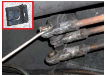
Eine Schaltstange wird ausgehebelt. Links oben sieht man im Detail eine Klammer mit der die Stangen in der Führung arretiert sind.
