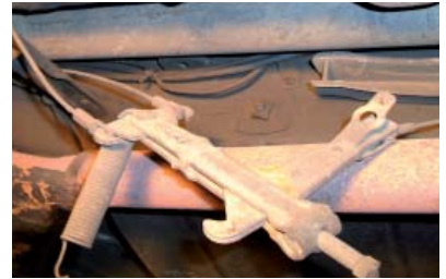
Die ausgegangene Mechanik des Handbremszuges. Die Schraube rechts dient übrigens zur Einstellung des Handbremsseils. Bei dieser Demontage muß das Seil aber nicht neu eingestellt werden.
