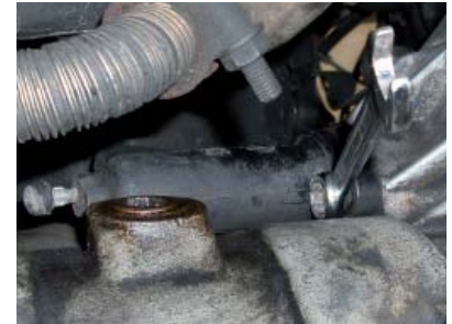
Rechte Getriebeseite: Der Kupplungs- geberzylinder ist mit zwei Schrauben am Getriebe befestigt.
