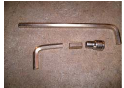
Eine Inbusnuss kann man zur Not selbst herstellen, indem man einen Handinbusschlüssel absägt und dann in eine passende normale Nuss steckt.
