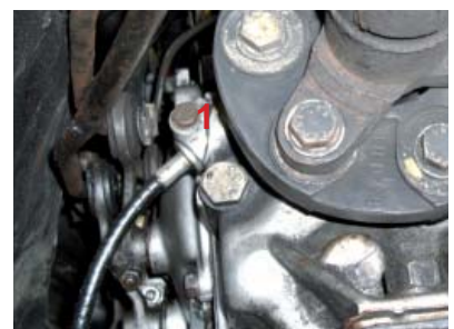
Links oben am Getriebe ist die Tachowelle befestigt. 1 Diese Schraube muß ab.
