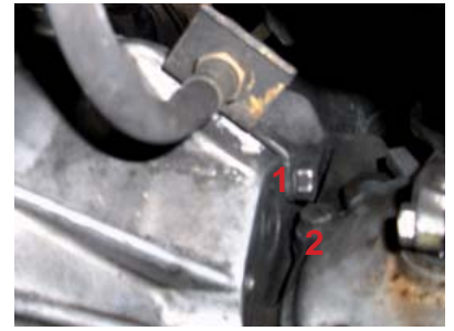
Linke Getriebeseite: Der Halter der Hydraulikleitung muß ab (Schraube 1). Wenn der Platz nicht reicht vorher die Getriebedeckelschraube (2) rausnehmen.
