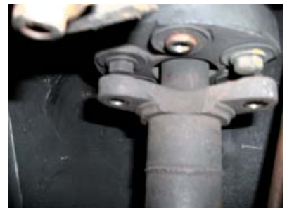
Die Kardanwelle ist bereits von der Hardyscheibe abgeschraubt worden. Jetzt muß sie so weit nach hinten gedrückt werden, sodass auch der in der Mitte sichtbare Zapfen frei kommt und die Welle vorne abgenommen werden kann.
