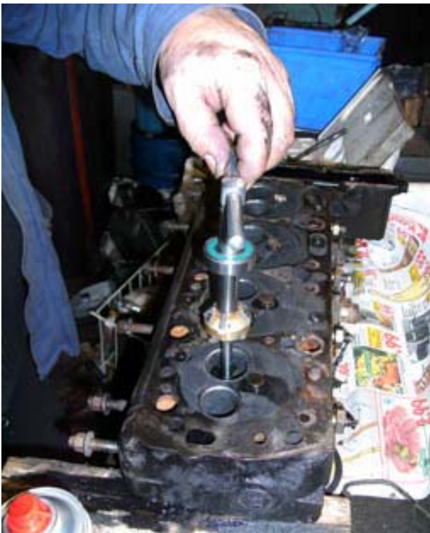
Ventilsitze einschleifen mit Spezialwerkzeug.
