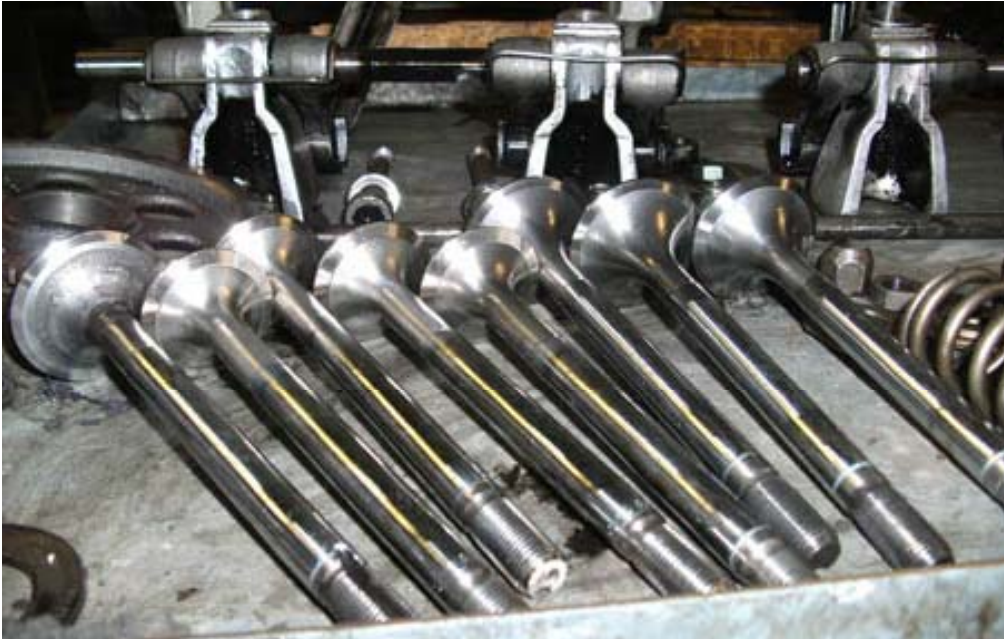
Neu geschliffene Ventile. Entscheidend ist nur der äussere Rand an den Tellern.
