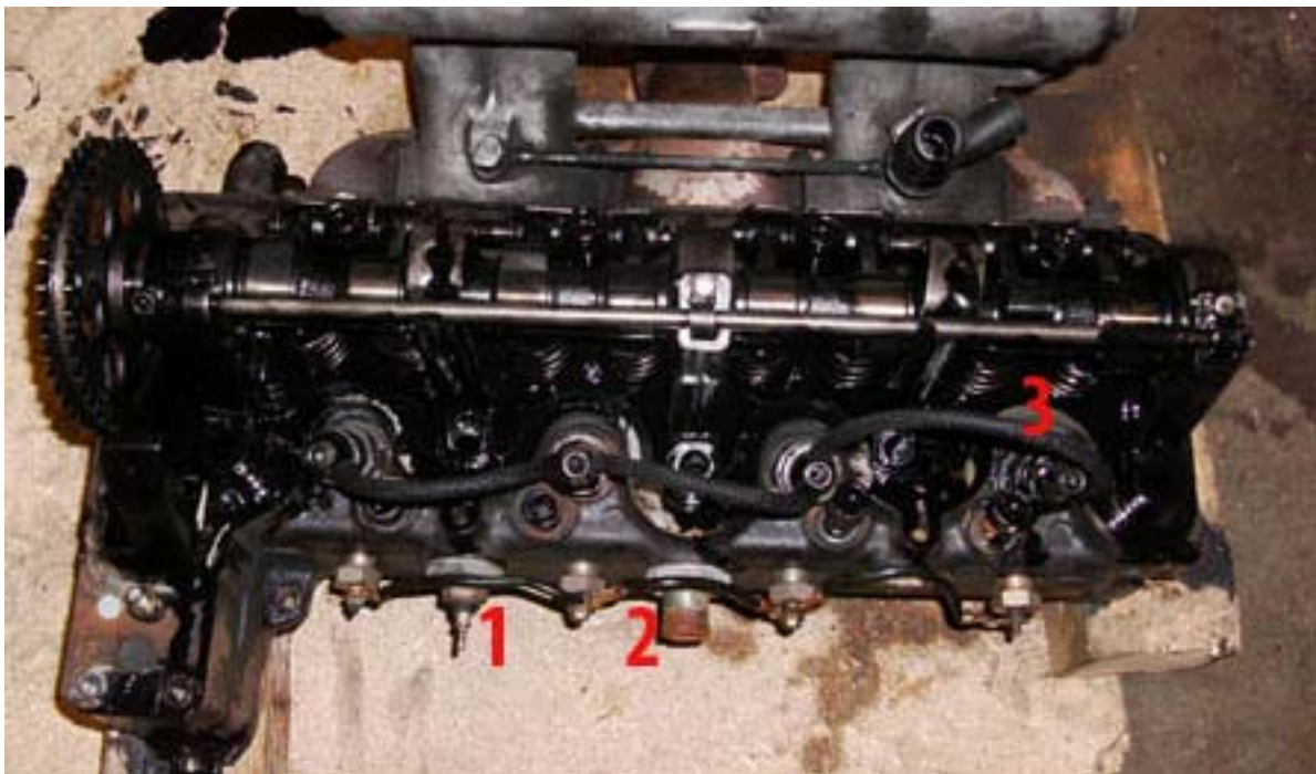
Demontierter Kopf: 1: Temperaturfühler, 2: Wasseranschluß rechts, 3 Überlaufschlauch Einspritzdüsen
