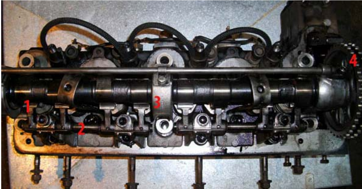
Demontierter Kopf: 1: Kipphebel, 2: Welle der Kipphebel, 3: Lagerblock Nockenwelle, 4: Nockenwellenrad
