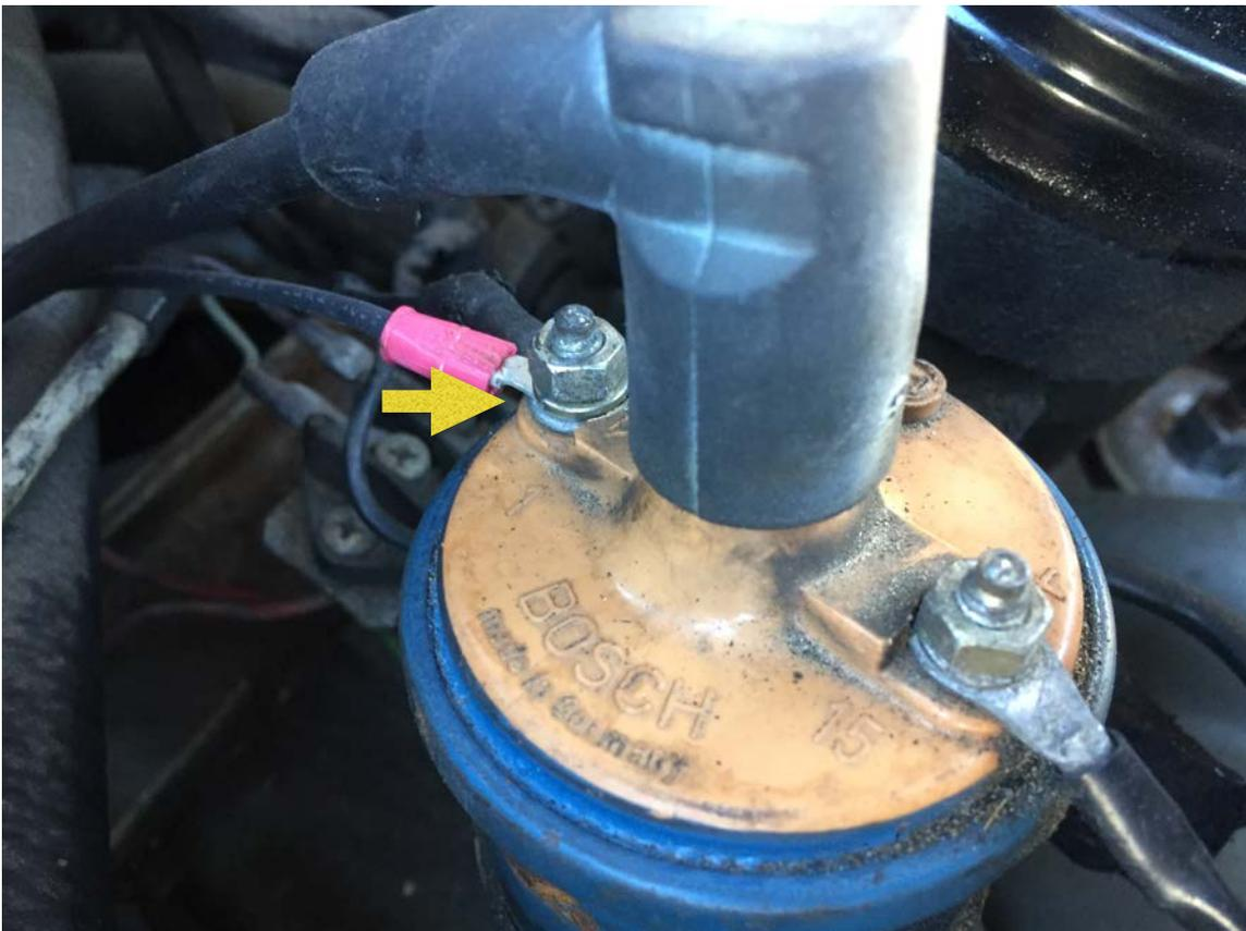
Das rote Kabel soll am Plus der Zündung angebracht werden und der Ignitor bedarf keiner Vorwiderstände, diese müssen daher überbrückt werden. Ich habe das Kabel vom Zündschloss verfolgt (siehe oberer Pfeil), es geht in der ersten und dann in den zweiten Vorwiderstand. Es ist daher am einfachsten das rote Kabel des Ignitors am Eingang des ersten Widerstand anzubringen (siehe unterer Pfeil) - d.h. Richtung Motorinnenraum:
