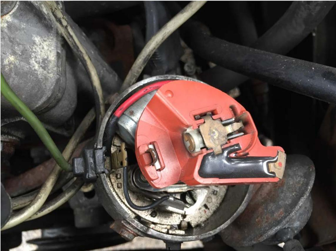
und Verteilerfinger abziehen:
