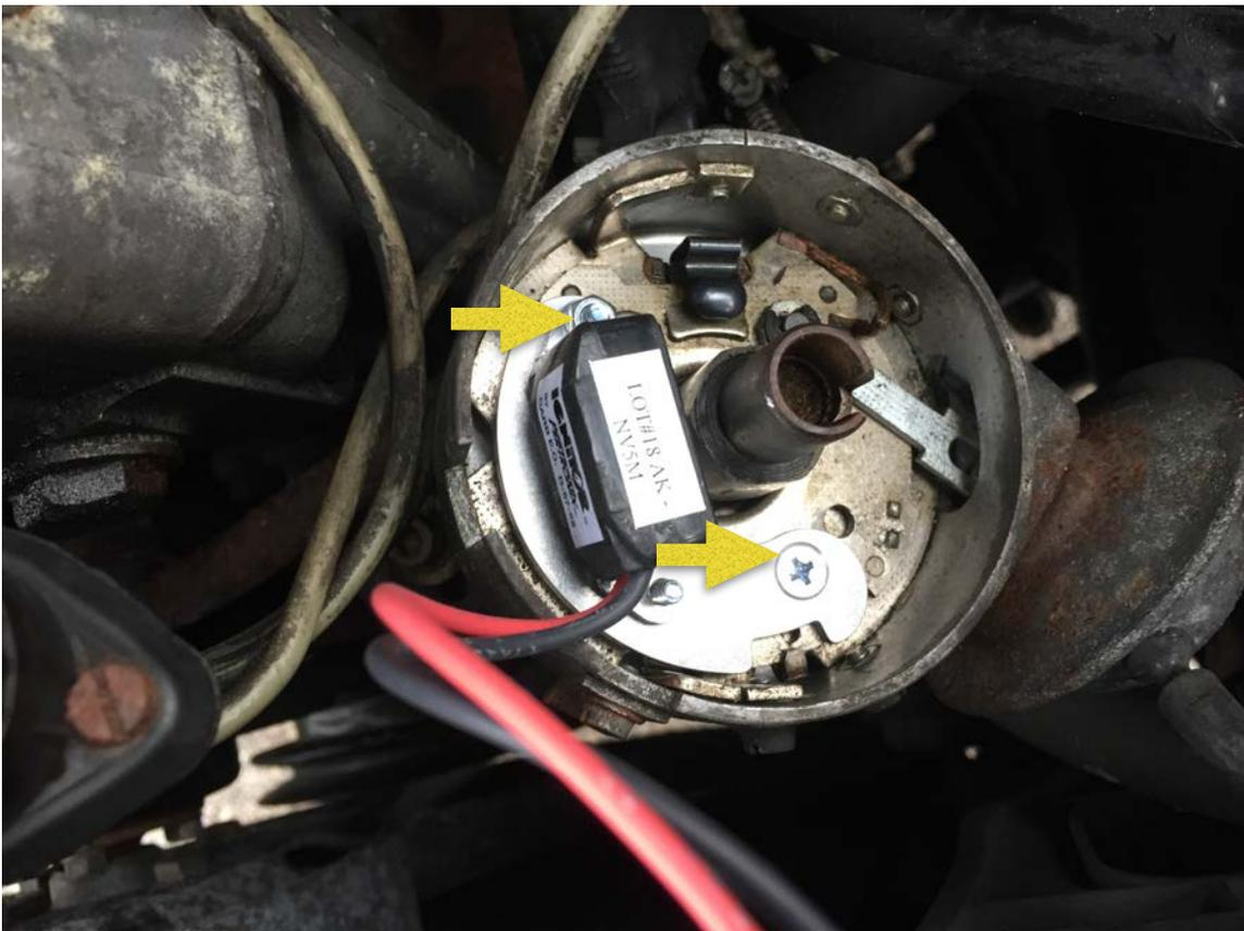
Beide Muttern befestigen und Magnetscheibe aufstecken:
