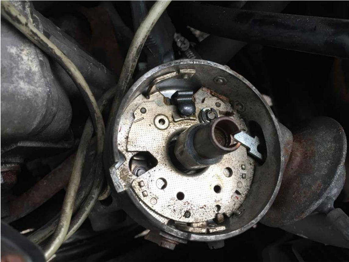
Ignitor Grundplatte aufschrauben und Ignitor befestigen:
