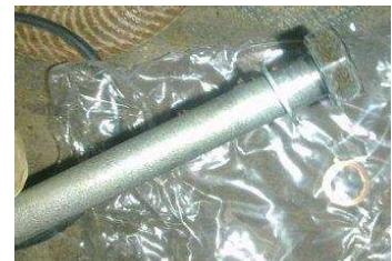
Abbildung 8: hier sieht man schon auf der Befestigungsschraube den neuen Alu-Dichtring
