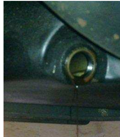
Abbildung 7: Hier läuft noch das alte Öl... (kann eine Weile dauern)
