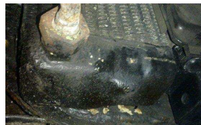
Abbildung 6: Der Ölkühler - hier ohne Ablassschraube. ansonsten wäre sie in der kleinen Ausbuchtung
