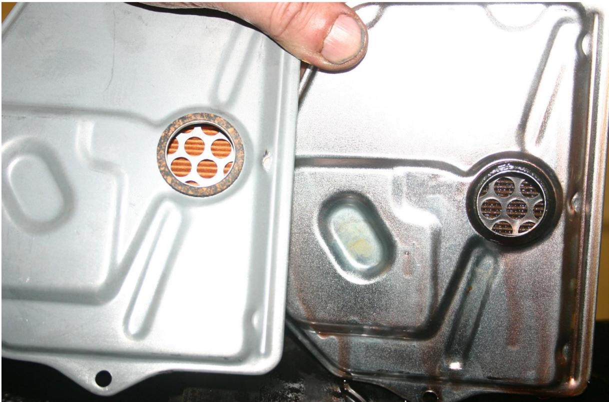
Bild 4 – Die Filter im Vergleich: neu (links) und alt (rechts)
