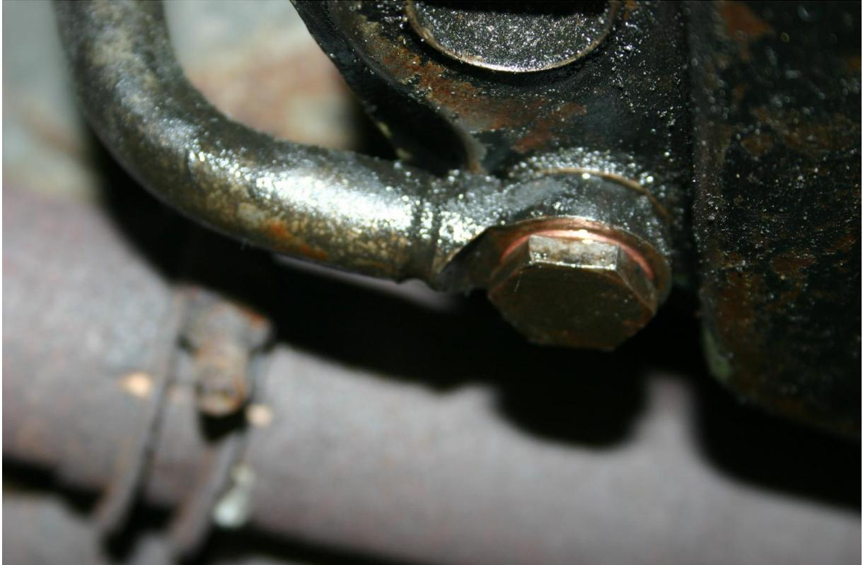
Bild 7 – Verschraubung von Ölstands-Peilrohr mit der Ölwanne
