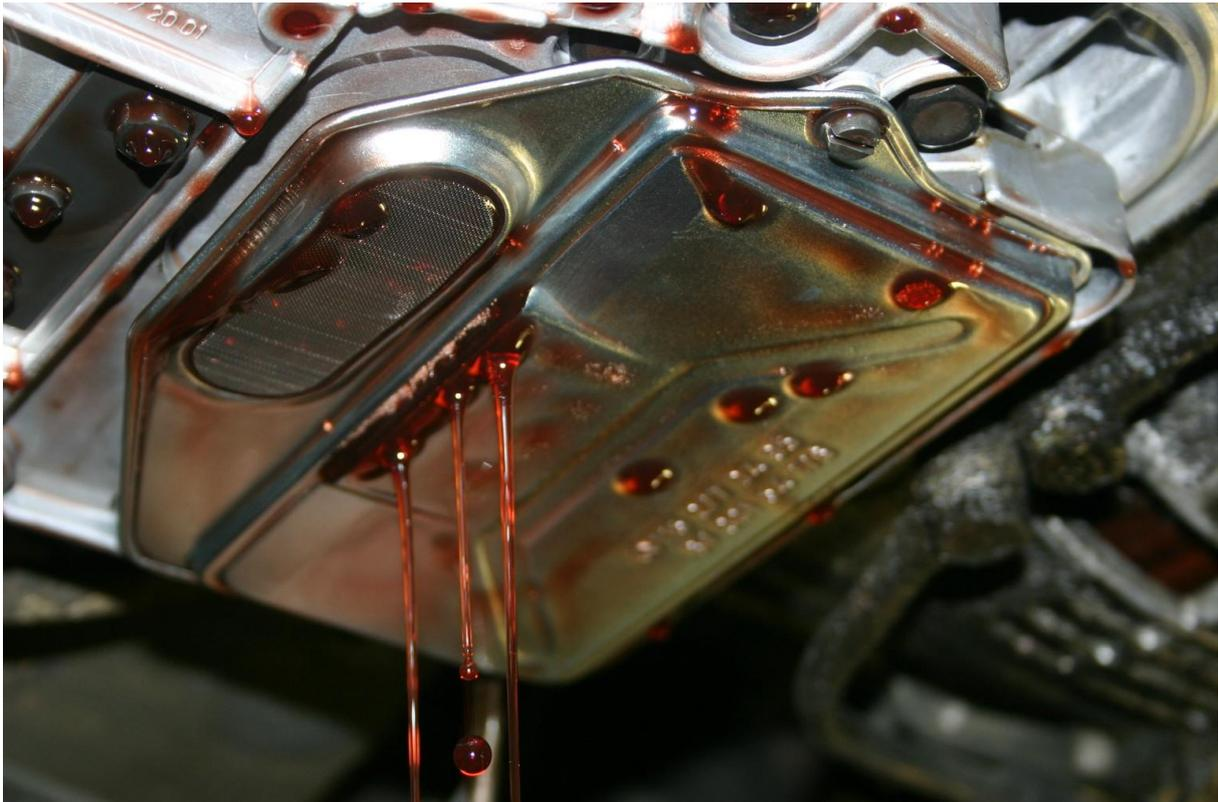
Bild 3 – Der alte Plattenfilter (noch am Getriebe montiert)
