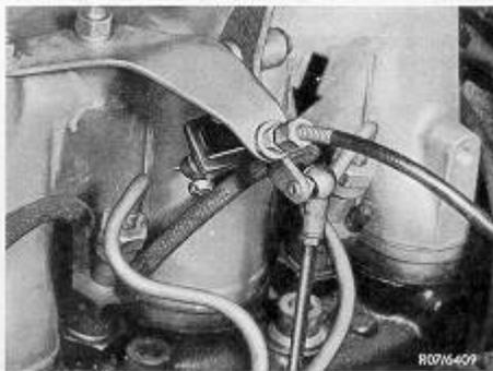
Abbildung 4: Lagerbock auf der Zylinderkopfhaube
