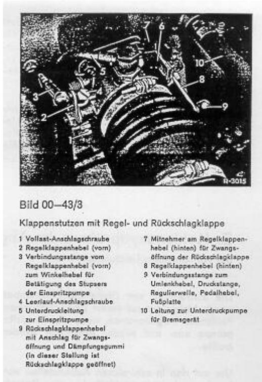
Abbildung 5: Klappenstutzen mit Regel- und Rückschlagklappe
